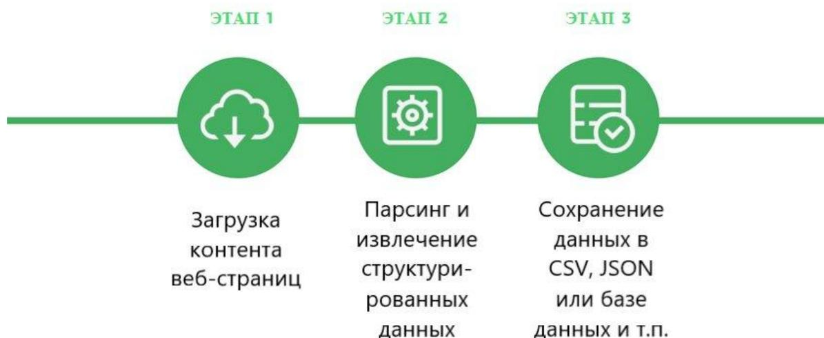
Рис. 2. Схема работы парсера.
